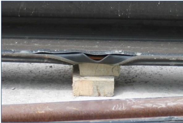
**Abb.23.1.1 Beschädigung des Fußprofils durch unsachgemäße Lagerung** (Quelle: Datwyler Sealing Technologies)
