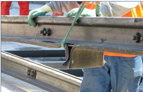
**Abb.18.3.4 Verschieben des Fußprofils durch Schlupf, der in Schienenlängsrichtung geneigt ist**
