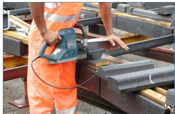
**Abb.23.1.8 Durchführung der Isolation im Werk** (Quelle: edilon)(sedra)
